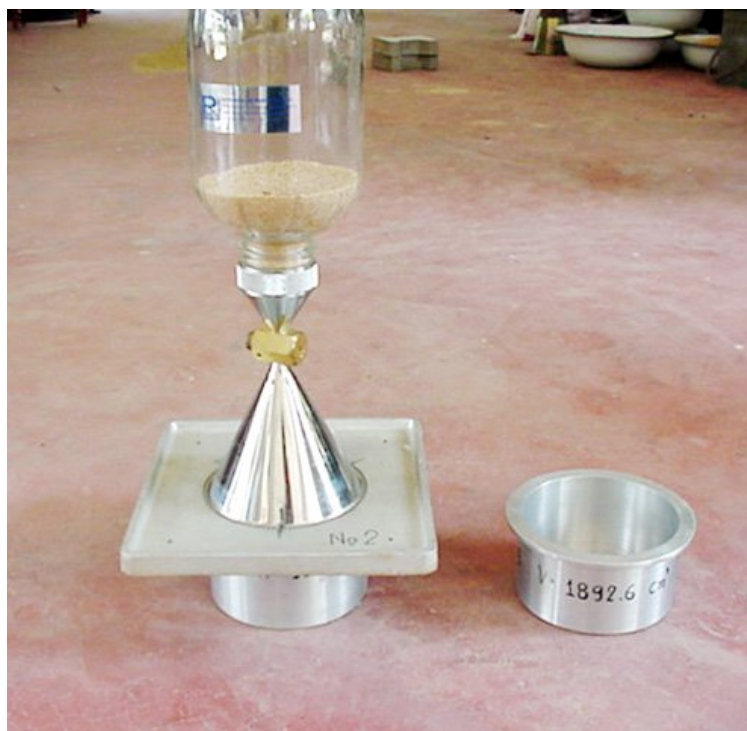
รูปที่ 1 การ Calibrated ทราย
